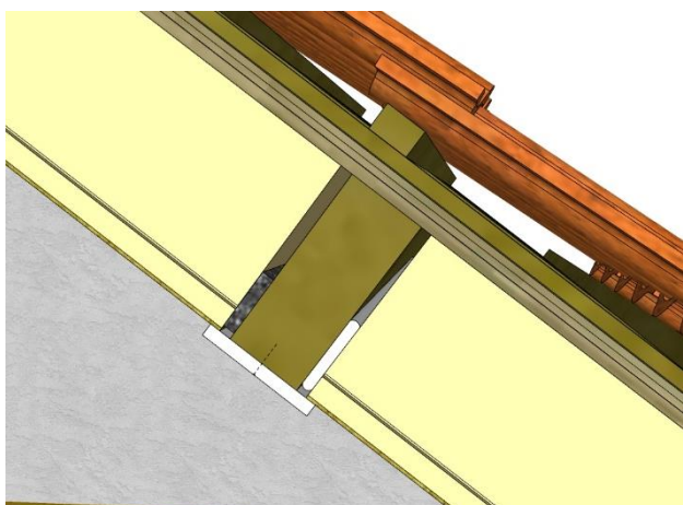
Figuur 9 - Detail met afwerklátten over de gording
